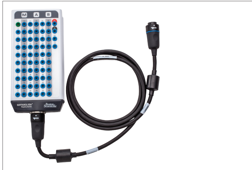
Figure 3. Boîte de dérivation et câble
